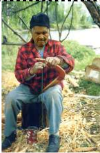
2 Mise en forme de l'étrave. Après avoir fendu le bois et l'avoir étuvé pour pouvoir le courber, la pièce est maintenue en forme pendant le séchage par un laçage.
