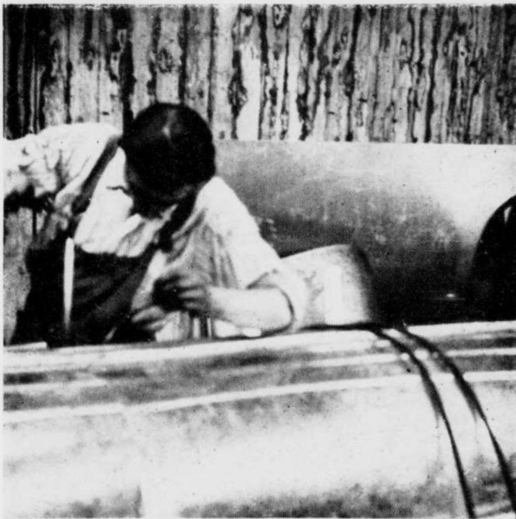
Un travail délicat nécessitant des soudeurs particulièrement habiles : Les soudures des deux parties du canoe.
